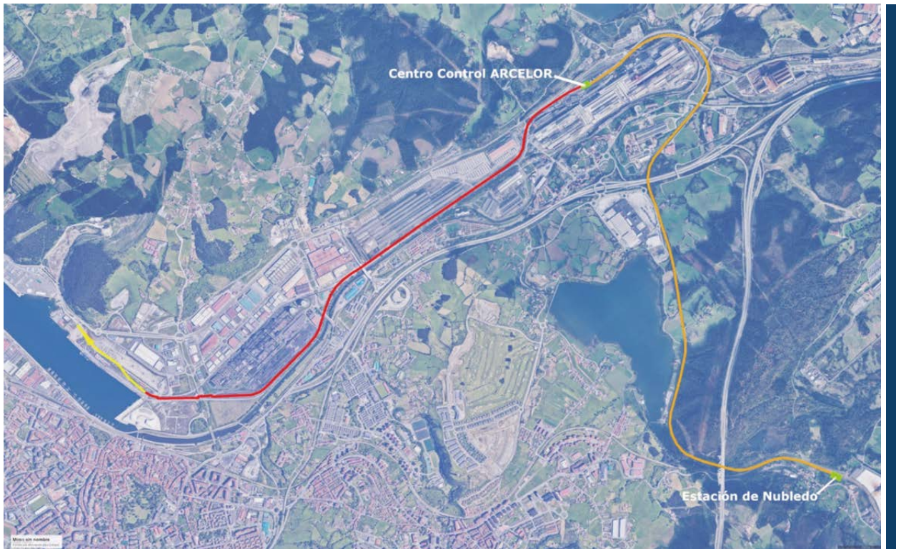
Fig.1 Esquema de vías de conexión del muelle de Valliniello con la RFIG en la Estación de Nubledo a través de los terrenos de ArcelorMittal. / Map of tracks linking the Valliniello quay with the General Interest Rail Network (RFIG) at Nubledo station through ArcelorMittal property.
