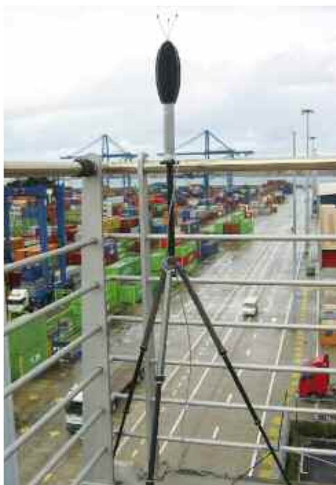
Medidor de emisiones acústicas
